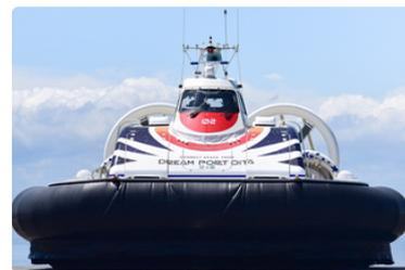
スカートに空気を送り込むと船体は約1.5m上昇し、全高は約9mに。
